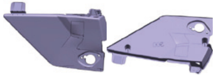
Konstruktion des zu testenden Bauteils. Aus CAD Daten von Audi wird von uns ein 3D Modell erstellt.
